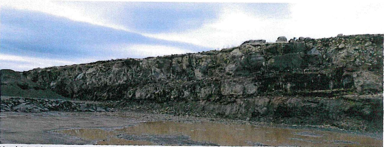
Mynd 6. Tvö hraunlög eru í námunni við Grundartanga og eru þau aðskilin af rauðu millilagi. Neðan við neðra hraunlagið er rautt millilag og set- eða túfflag.
