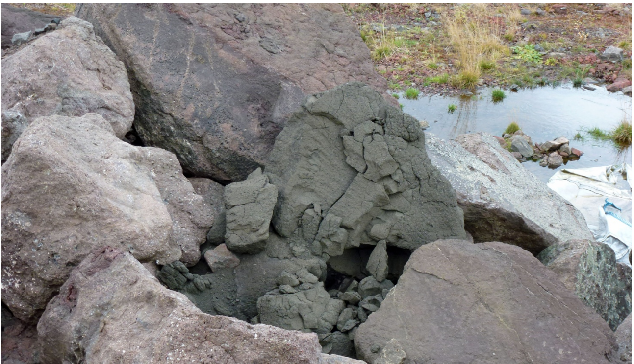
Mynd 9. Steinar sem fást úr setlaginu undir hraunlögunum í námunni á Grundartanga molna undan sjálfum sér.
